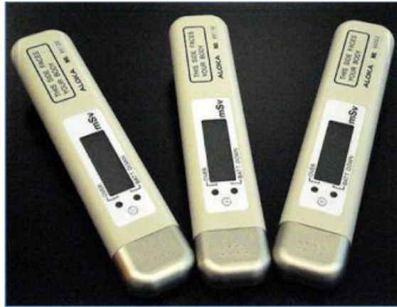
شکل ۹۱ - نمونه دزیمترهای جیبی نوع دیجیتال
