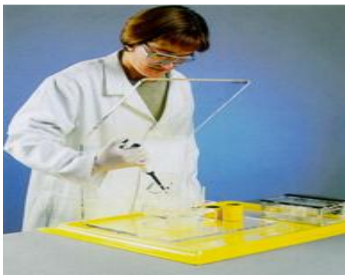
شکل ۹۶ - حفاظ سربی شفاف در مراکز پزشکی هسته‌ای در مواجهه با ذره بتا
