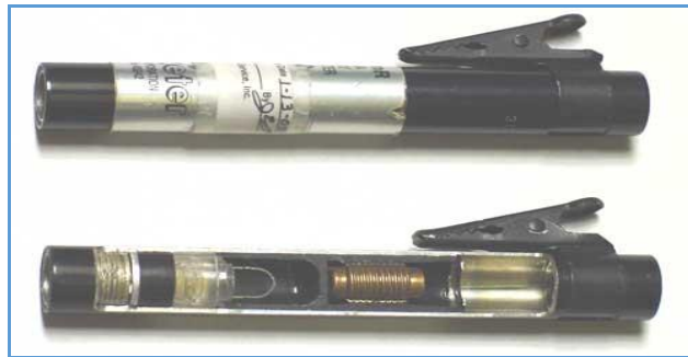
شکل ۸۹- دزیمتر جیبی نوع قرائت شونده Self-Reading
